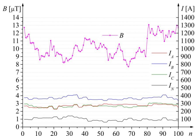
СЛИКА 6 – Резултати дуготрајног мерења магнетске индукције у тачки А
